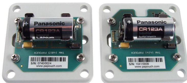
obr. 26 - TMW I (vlevo) a THW I (vpravo) bez víčka
