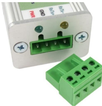
obr. 2 - Konektor pro napájení a senzory na TME multi
