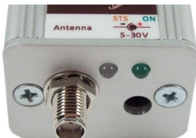
obr. 3 - Konektory pro napájení a anténu na TME radio
