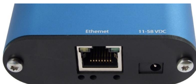
obr. 4 - Konektor pro Ethernet a pro alternativní napájení na TME radio PoE
