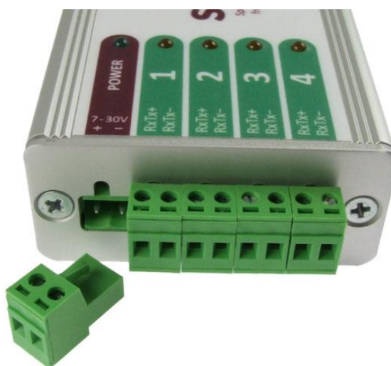
obr. 2 - všechny svorky jsou jednotlivě odnímatelné
