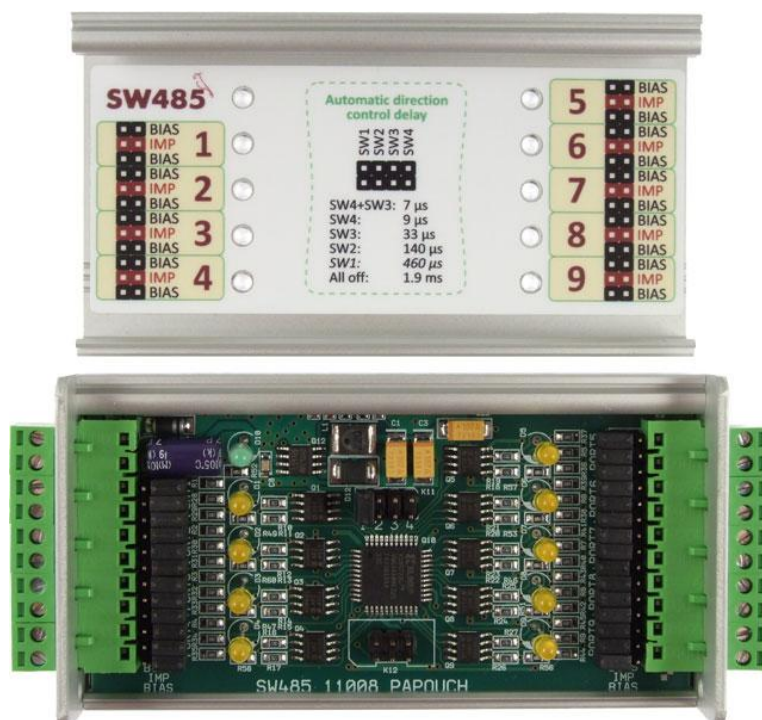
obr. 4 – deska elektroniky uvnitř krabičky a informační štítek zespoda na víku
