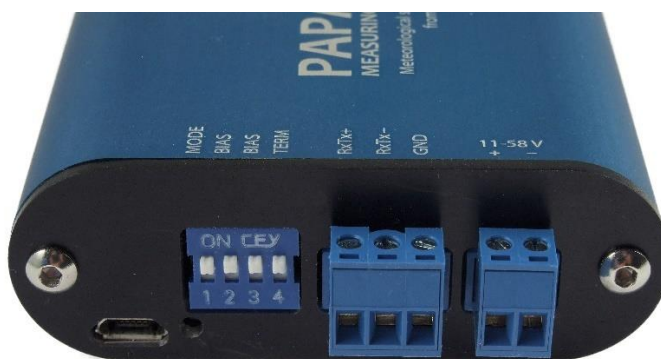
obr. 2 - čelo s konektory pro RS485, napájení a konfiguračním USB
