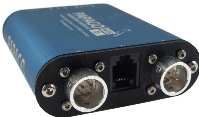
obr. 1 - čelo s konektory pro připojení senzorů
