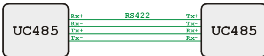
obr. 17 – Příklad zapojení systému propojeného linkou RS422. Oba moduly mají připojeno zakončení.
