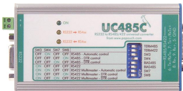
obr. 2 – UC485C (konektor D-SUB 9M na RS485/422)
