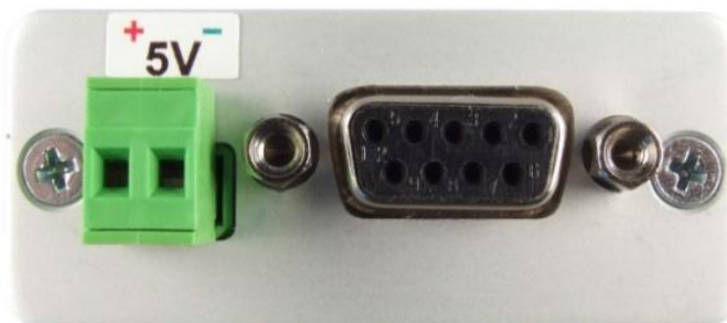
obr. 10 – UC485 s nestandardním napájením je označeno doplňkovým štítkem (příklad 5V verze)
