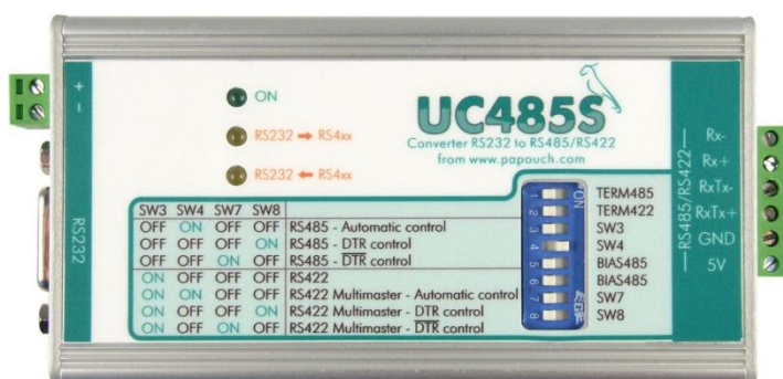
obr. 3 – UC485S (násuvná šroubovací svorkovnice na RS485/422)
