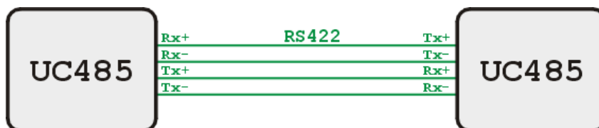
obr. 2 – Příklad zapojení systému propojeného linkou RS422. Oba moduly mají připojeno zakončení.
