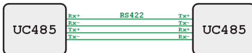
obr. 6 – Příklad zapojení systému propojeného linkou RS422. Oba moduly by měly mít připojeno zakončení.
