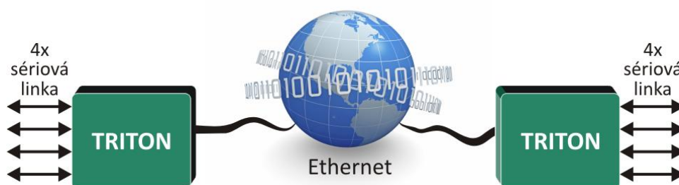
obr. 2 – On-line přenos čtyř sériových linek přes Ethernet
