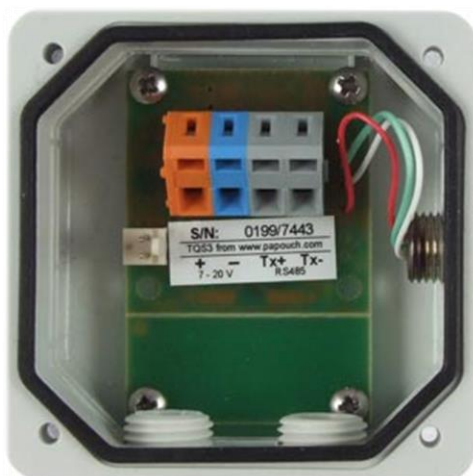
obr. 2 – svorkovnice uvnitř krabičky
