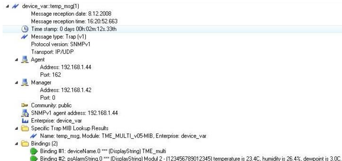
obr. 7 – Ukázka SNMP trapu s hodnotou z THT
