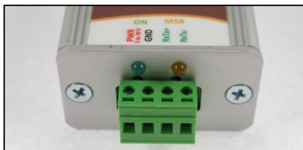
obr. 7 – odnímatelné svorky na THT2
