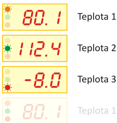
obr. 2 – způsob zobrazení více teplot na jednom displeji. Teploty na displeji rotují automaticky po třech sekundách. Pro identifikaci teploty slouží kontrolky po straně displeje.
