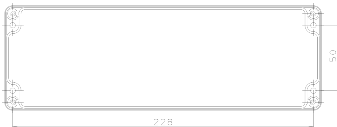
obr. 6 – umístění a rozteč montážních otvorů na krabičce
