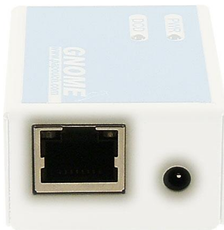
obr. 2 – Konektory Ethernetu a napájení
