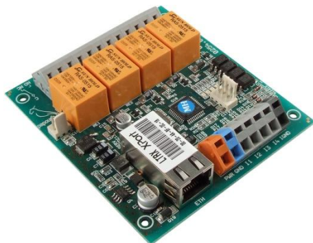
obr. 12 – Quido jako samostatná deska elektroniky
