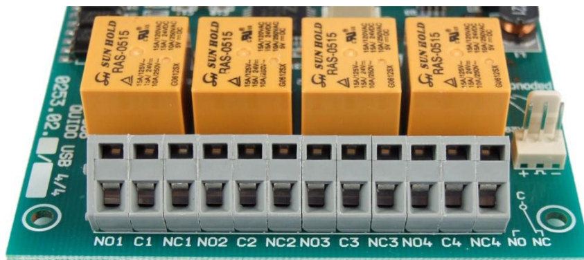
obr. 3 – ukázka svorkovnice relé na Quidu USB se čtyřmi výstupy (ukázka Quido USB 4/4)
