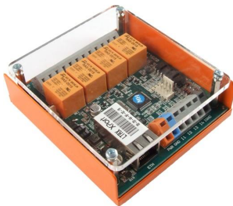
obr. 15 – Quido v plechové krabici s plexi krytem
