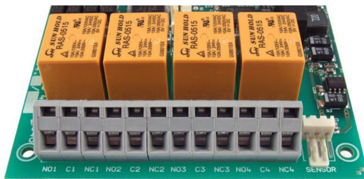
obr. 17 – přepínací kontakty výstupních relé
