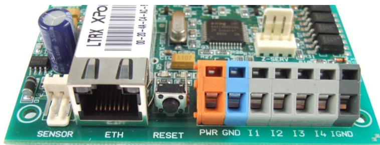
obr. 6 – příklad konektorů na Quidu ETH 4/4 (zleva): senzor, ethernet, napájení a vstupy
