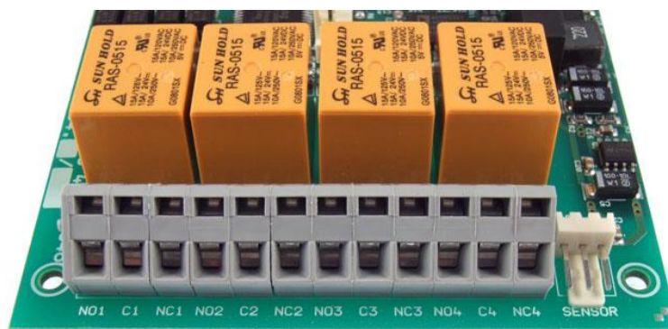
obr. 13 – přepínací kontakty výstupních relé
