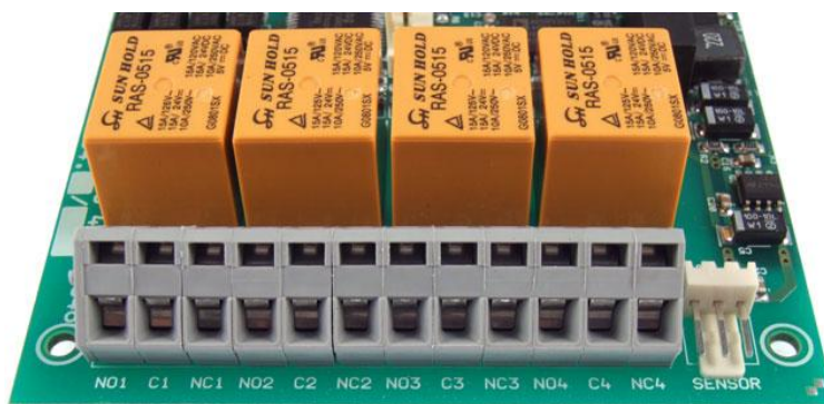
obr. 7 – přepínací kontakty výstupních relé
