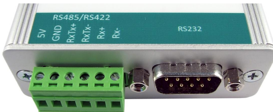
obr. 3 – Svorkovnice pro připojení RS485/422 a RS232
