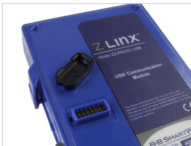
obr. 1 - Sejmutá krytka propojovacího konektoru na programátoru
