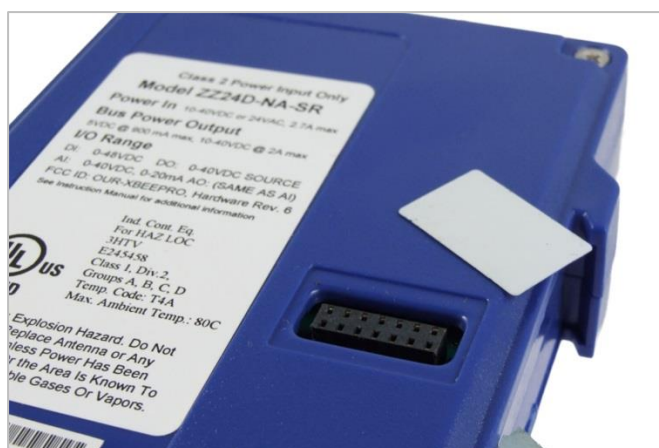
obr. 2 - Odloupnutá krytka komunikačního konektoru na I/O modulu
