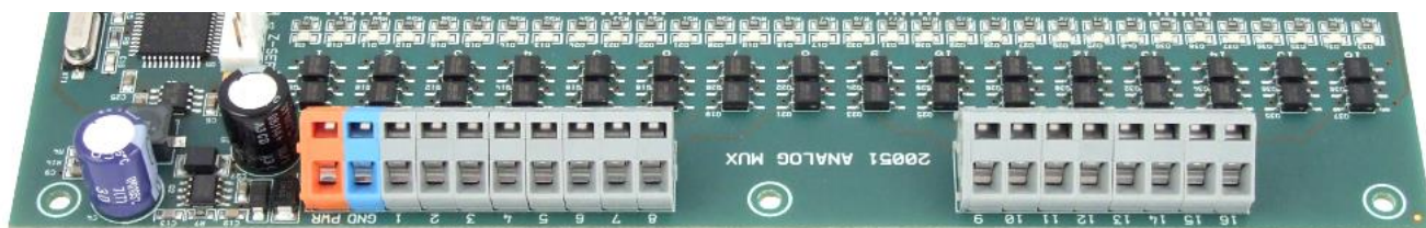
obr. 3 - Připojení druhé poloviny I/O a napájení
