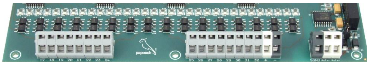
obr. 2 - Připojení jedné poloviny I/O a sériové linky
