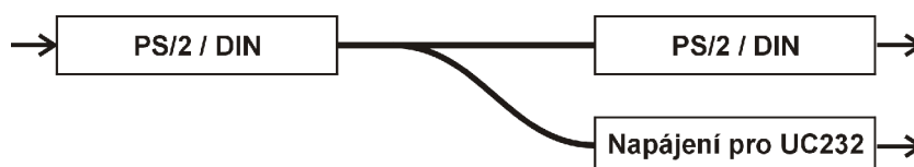
obr. 4 – blokové zapojení napájecího T kabelu pro RS232
